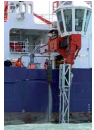
Das Schwerelot, mit dem ein Sedimentkern aus dem Meeresboden gewonnen wurde, kommt zurück an Bord. Foto: IOW
