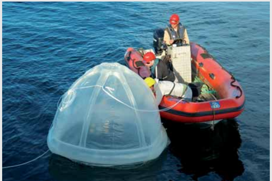
Der Mikrobiologe Christian Stolle nimmt vom Schlauchboot Proben aus einem schwimmenden „Mesokosmos“. Die futuristisch anmutende Kunststoffkuppel fängt Spurengase ein, die von Cyanobakterien zum Beispiel dann abgegeben werden, wenn sie zu viel Sonnenlicht abbekommen. Foto: vdL / IOW
