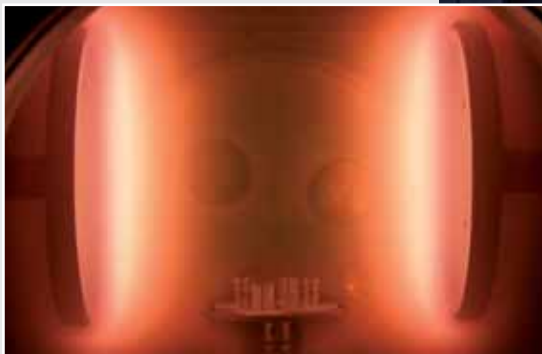
Veredelung einer Oberfläche mit einem Plasmasystem, das im INP entwickelt wurde.
