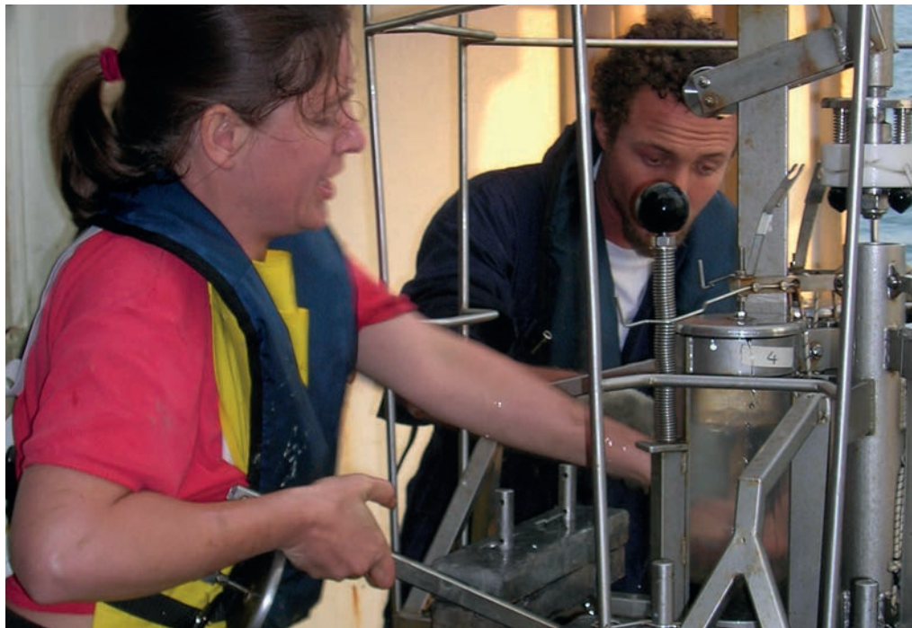
Heide Schulz-Vogt in Aktion: mithilfe eines so genannten Multicorers wurden Proben vom Meeresboden an Deck geholt. (Quelle: MPI Bremen).
