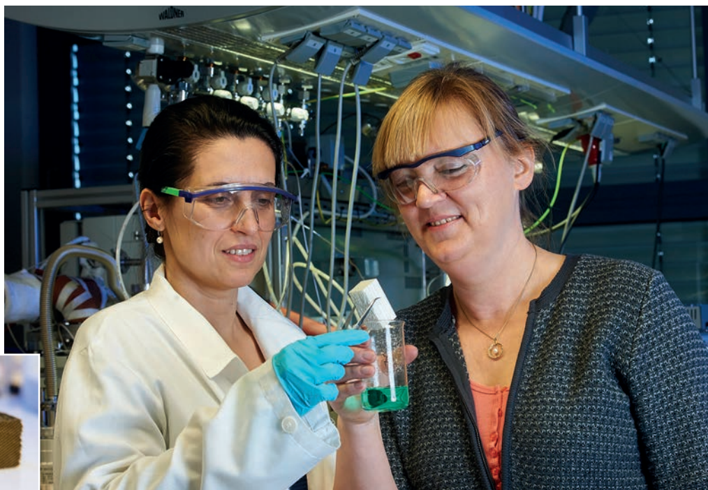
Heike Ehrich (rechts) und Elka Kraveva beim Beschichten des Monolithen mit dem Katalysator. Kleines Bild: Monolithe aus mineralischer Keramik, die als Matrix für den Katalysator dienen. Fotos: LIKAT
