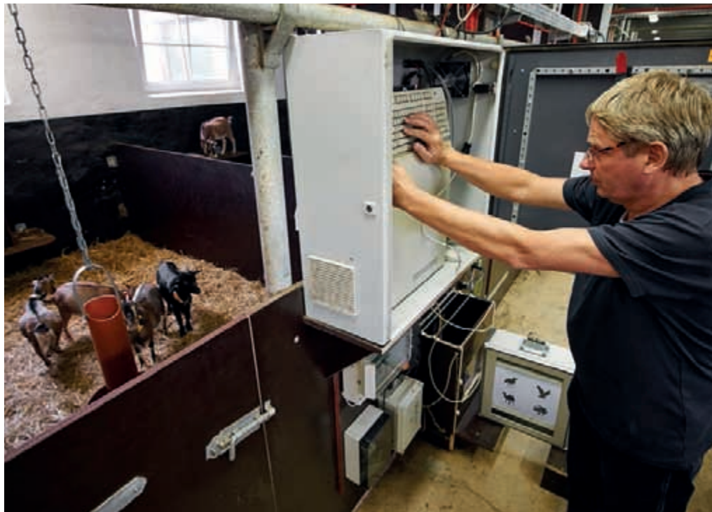
Versuchsstall. In jedem Haltungsabteil für Gruppen von zehn Zwergziegen steht ein Lernautomat mit Bildschirm und notwendiger Steuertechnik zur Verfügung. Dieter Sehland, technischer Mitarbeiter, bereitet ein Experiment vor. Foto: FBN
