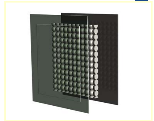
DBE-Struktur nach (a) (Explosionsdarstellung: Transparente Elektrode – Dielektrikum – Kugelstruktur – Gegenelektrode)
