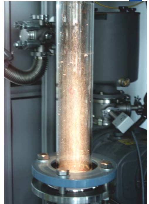
Plasmabehandlung von Kohlenstofffasern in einer Wirbelschicht
