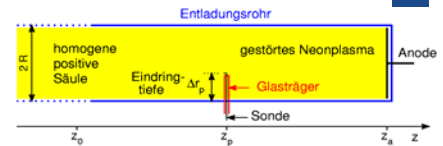
Abb. 1: Langmuir-Sonde im Übergangsbereich zwischen positiver Säule und Anode
