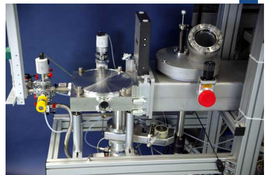
Derivatisierungskammer für den quasi-in-situ Nachweis von Oberflächenradikalen mit Hilfe des Radikalfängers NO
