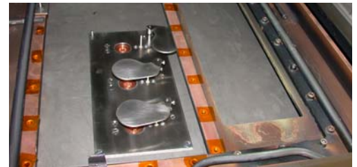
Sondenplatte zur Bestimmung der Plasmaparameter im Substratraum unterhalb der Magnetrons
