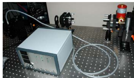
Messaufbau zur Cavity-Ring-Down-Spektroskopie mit Q-MAC-System
