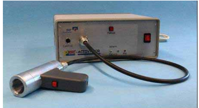
Plexc-Handgerät bestehend aus Plasmakopf, Verbindungskabel und Mikrowellenversorgung
