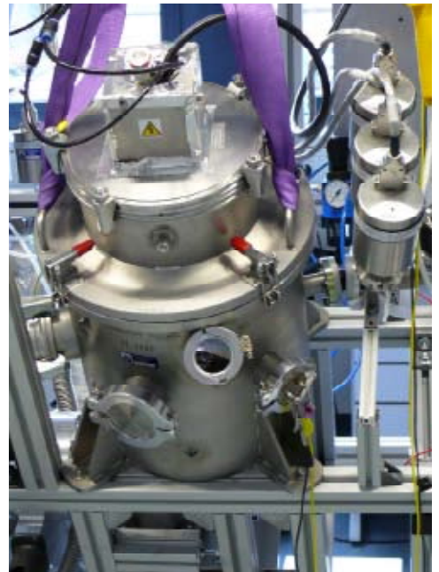
Sputterreaktor für die Metallisierung vom Pulvern
