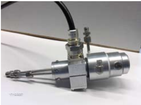
Mobiler Plasmakopf für die industrielle Anwendung
