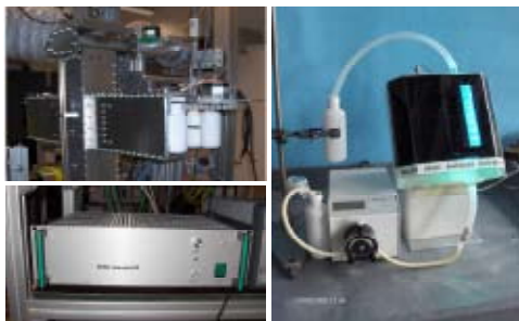
Links oben – Flaschenmodul mit Transportkette für Flaschen; links unten – Leistungsnetzteil (Eigenentwicklung); rechts – UV-Behandlungsstation für halbflüssige Präparate
