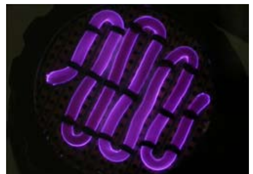
Oberflächenentladung bei Atmosphärendruck in Argon
