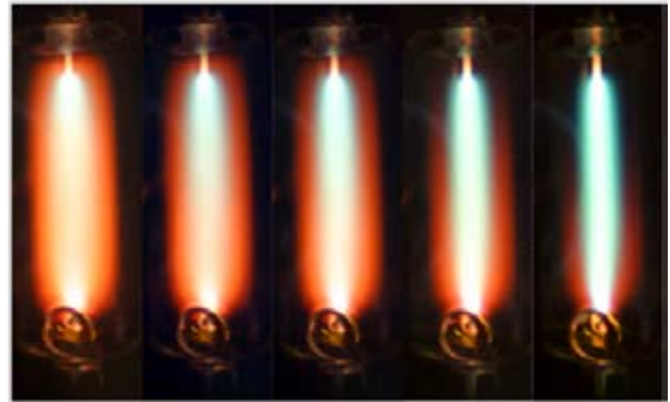
Entmischung des Lampenplasmas einer HID-Modelllampe mit Hg/Nal Füllung beim Dimmen von 150 => 50 W
