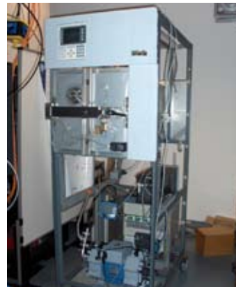
Abbildung 2: 62 l Plasmareaktor für Applikationstests
