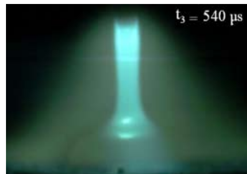
Gefilterte Hochgeschwindigkeitsaufnahme eines Schweißlichtbogens mit deutlicher Ausbildung eines Metalldampfkerne
