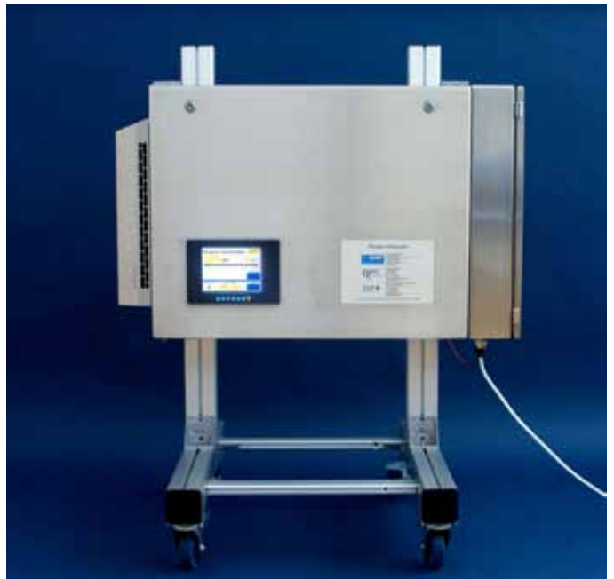
Abb. 1: Kompakter und transportable Demonstrator des Phosgenanalysators
