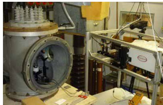
Mobile Anlage des INP zur Emissionsspektroskopie (rechts) am Modellschalter der RWTH Aachen (links im Bild)
