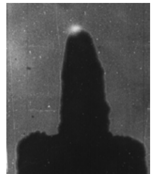
Schema der Entladungsanordnung in der Vakuumkammer und Bild der Elektrodenansatz mit Spotansatz
