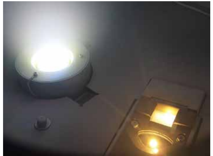
PIAD-Prozess: Blick auf die Plasmaquelle APS (Advanced Plasma Source, links) und den Elektronenstrahlverdampfer (rechts)
