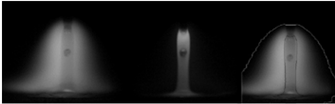
Synchrone Aufnahme des Lichtbogens (linkes Bild) mit Filtern im Bereich von Argonlinien (links) und im Bereich von Eisenlinien (rechts) sowie Beispiel einer Bildauswertung (rechtes Bild).
