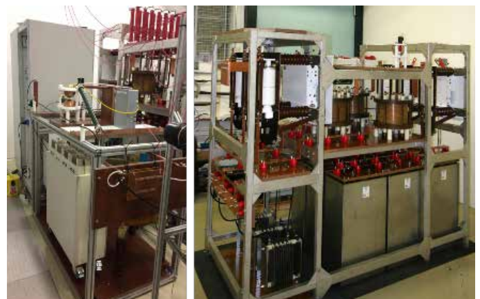
Der neu aufgebaute Überschwingungsgenerator „Dora“ (links) und Hochstromgenerator „Caesar“ (rechts) im Lichtbogenlabor des Instituts
