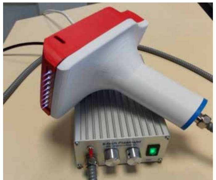
Labormuster eines Plasmajet-Arrays für medizinische Anwendung auf Basis des kINPen MED® für die Behandlung größerer Flächen
