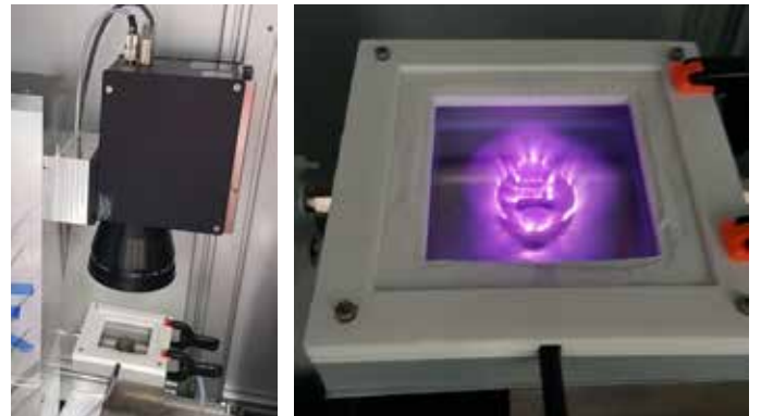
Abbildung 1: Links: Skannerkopf mit flächiger Plasmaquelle; rechts: flächige Plasmaquelle mit Dentalimplantaten.
