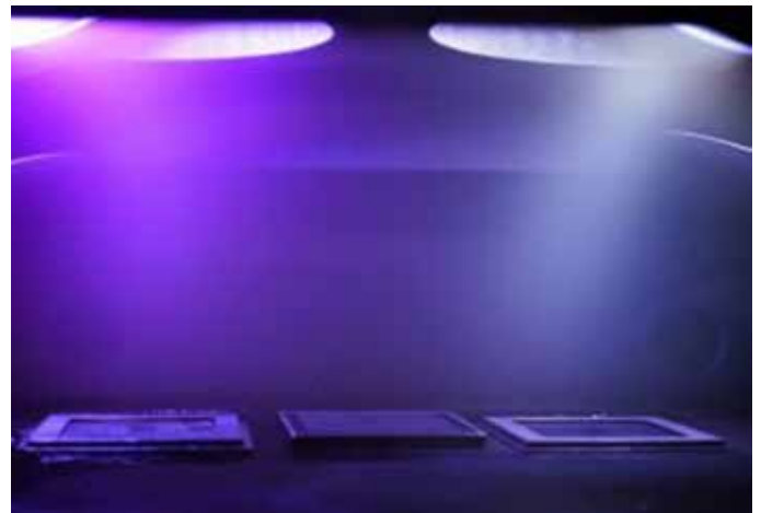
Herstellung einer Nanokompositschicht zur Thematik Materialien zur Energiespeicherung und -wandlung mittels PVD-Verfahren
