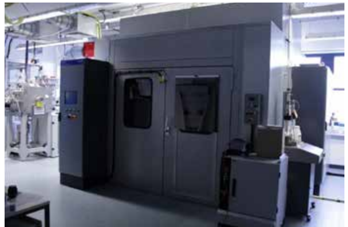
Industrieanlage für das thermische Atmosphärendruck-Plasmasprayverfahren zur Herstellung von Funktionsschichten
