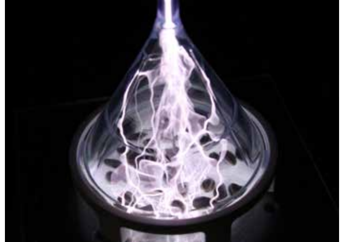
Behandlung von Sonnenblumenkernen durch eine Koronaentladung. Durch die Behandlung werden Mikroorganismen auf der Oberfläche der Körner abgetötet. Zudem erhöht sich ihre Wasseraufnahmefähigkeit und Stoffwechselprozesse werden angeregt.
