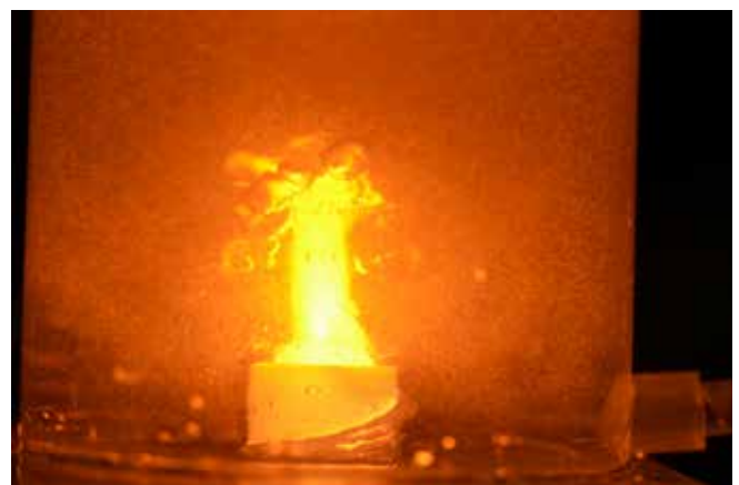
Mikrowellenplasma (2,45 GHz) in Wasser bei Atmosphärendruck
