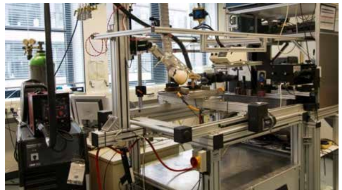
Setup für die Durchführung von Schweißversuchen mit fester Brennerposition und bewegtem Werkstück verbunden mit Einrichtungen für die abbildende Spektroskopie und Hochgeschwindigkeitskinematographie.
