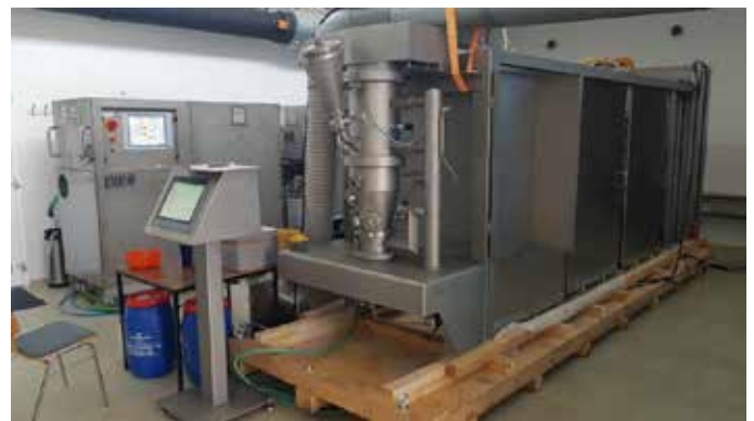
Wirbelschichttrockner mit Plasma-Gasgeneratoren (ADU)
