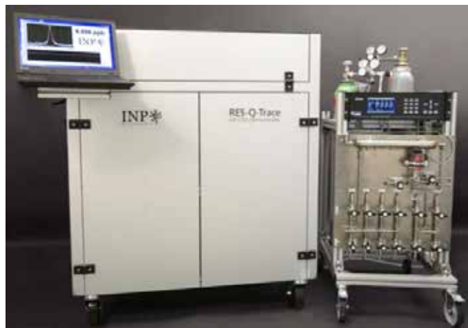
RES-Q-Trace - Demonstrator eines resonatorbasierten, quantenkaskaden-lasergestützten Spurengasanalyzers für die hochempfindliche Spurengasdetektion.
