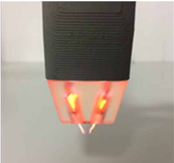
V-Jet: Neon-betriebener Dual-Plasmajet für die Krebsbehandlung
