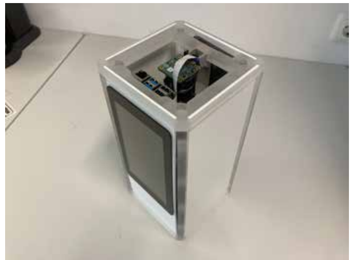
Kamerabasiertes Materialerkennungssystem. Die obere Abdeckung wurde entfernt, um den Blick auf die Kamera freizugeben.
