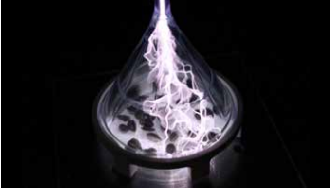
Kleinskalige Saatgutbehandlung mittels Coronaentladung (Trichter-Plasmaquelle)
