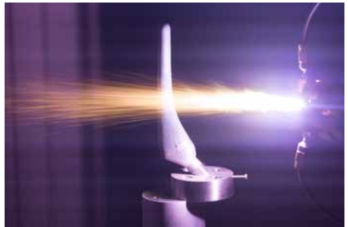
Thermisches Atmosphärendruck-Plasmasprayverfahren zur Herstellung von Funktionsschichten. Hier gezeigt: Oxidschicht auf metallischem Implantat
