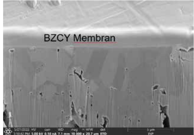
Protonenleitende elektrokeramische Dünnschichtmembran
