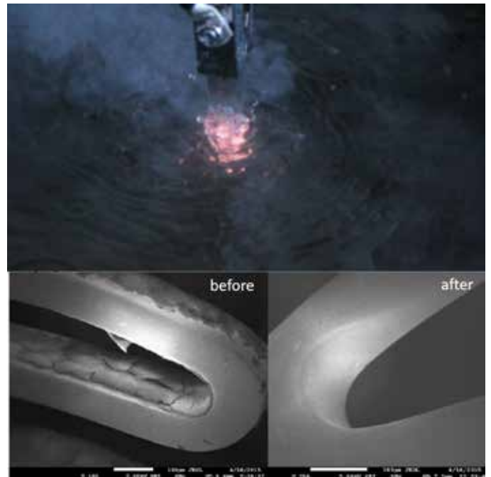
Plasma elektrolytisches Polieren im Einsatz als Feinreinigung und -Entgratung für Medizinprodukte
