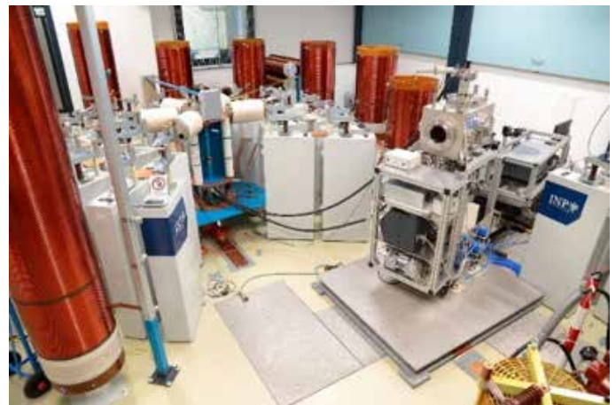
Hochstromgenerator zur Nachbildung verschiedener Stromverläufe im elektrotechnischen Bereich: AC-Pulse bis 200 Hz und 15 kA Amplitude, AC-Pulse bis 80 kA bei 50 Hz, DC-Pulse bis 20 ms Dauer und 10 kA Amplitude und Blitzstoßströme 10/350µs bis 50 kA max.
