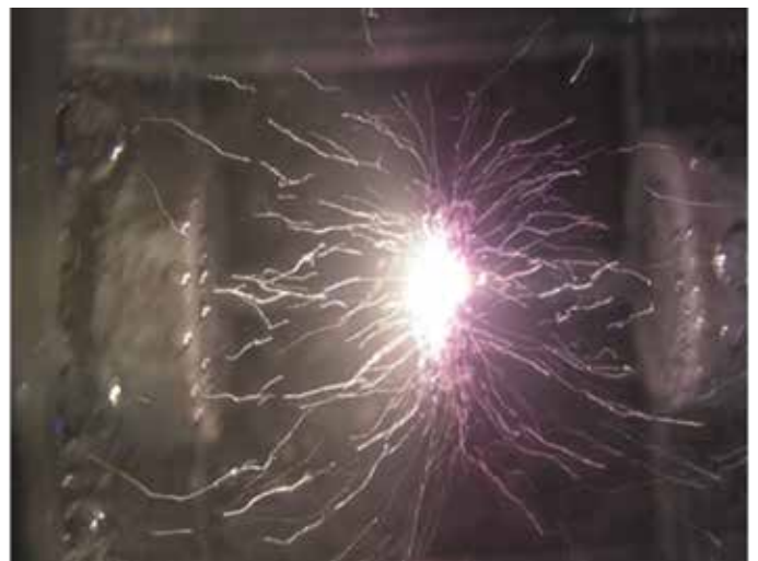
Elektrische Entladung in Flüssigkeiten: Synthese von Vanadiumoxid/ Graphen-Nanohybriden als innovative Batteriematerialien
