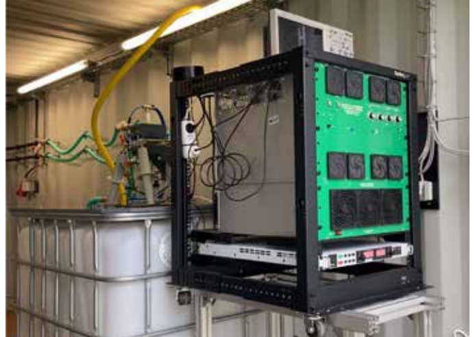
Plasmamodul in einem Demonstrator für die Behandlung von Prozess- bzw. Abwasser in der Zuckerfabrik Anklam. Zusammen mit anderen Verfahren, z. B. Ultraschall, Ultrafiltration, Ozonung und Aktivkohlefiltern, ist es das Ziel, das Wasser möglichst vollständig aufzubereiten, um es dem Produktionsprozess wieder zuzuführen.
