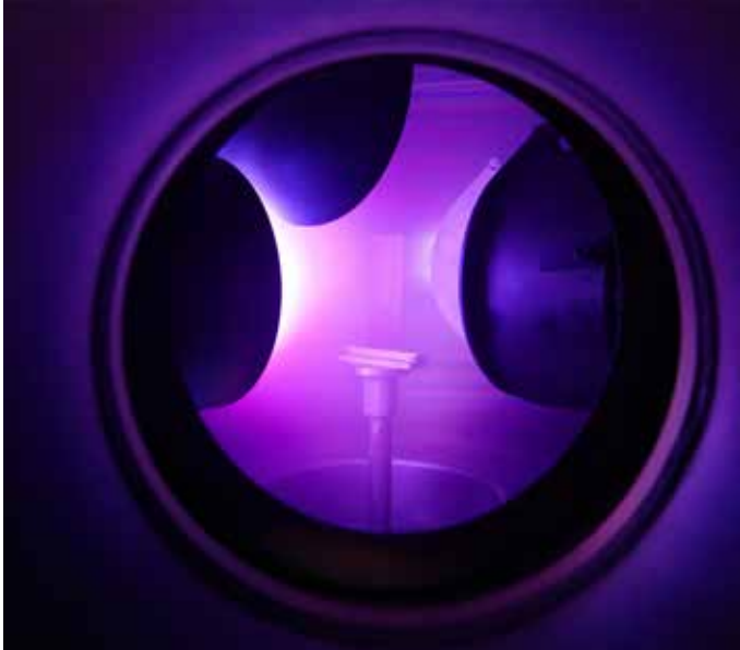
Beschichtungsverfahren: Herstellung von keramischen Schichten mittels PVD-Verfahren: Im Reaktor können 3 Ausgangsmaterialien simultan per Kathodenzerstäubung (Magnetron sputtering) verdampft werden.
