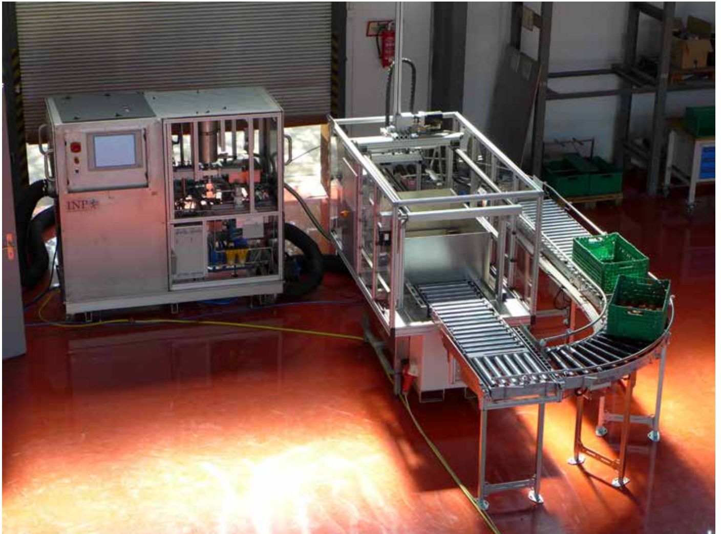
Behandlungsvorrichtung für Produkte in RPC (Reusable Plastic Container) mit Plasma-Gasgenerator (ADU)
