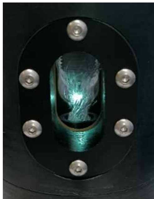
Sputter-Beschichtung eines tubularen Substrates mit einer protonenleitenden elektrokeramischen Dünnschicht
