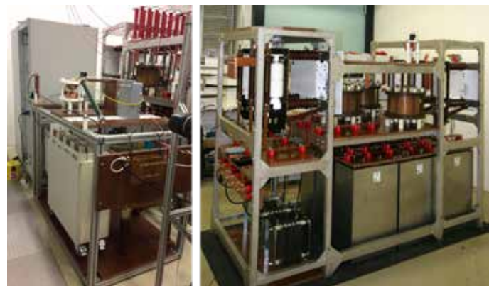
Links: Einschwingspannungsgenerator (TRV) bis 45 kV @ 1 kHz. Rechts: Hochstromgenerator (Weil-Dobke synthetic circuit type) bis 80 kA @ 50 Hz
