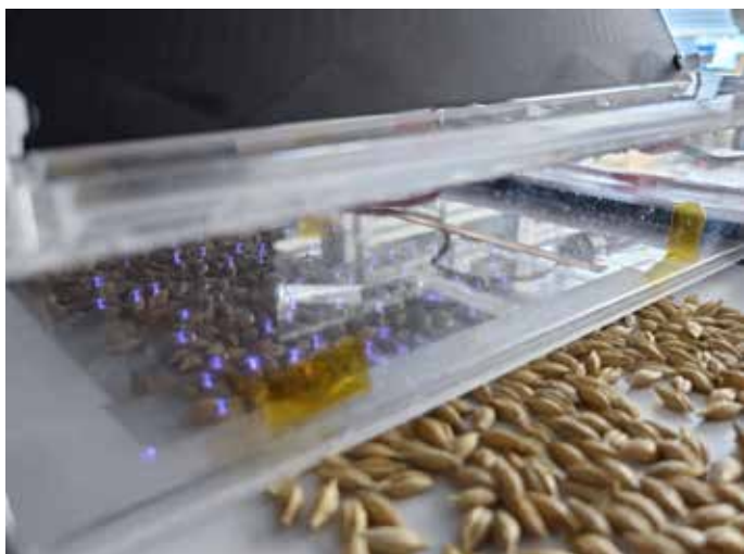
System zur gleichmäßigen Behandlung von Saatgut mit Atmosphärendruckplasma bei hohem Durchsatz.
