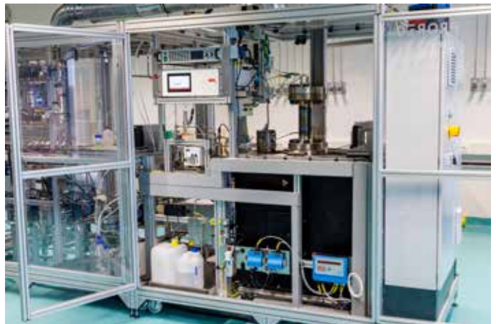
Hochdruck-Teststand zur Charakterisierung von röhrenförmigen Membran-Elektroden-Einheiten auf der Basis einer gesputterten protonenleitenden Perowskitmembranen für die Anwendung in der Festkörper-Ammoniaksynthese.
