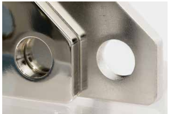
Plasma-Elektrolytisches Polieren: Vergleich eines polierten (links) und eines unpolierten Bauteils
