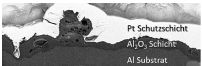
Oben: Kristallographische Untersuchungen im Röntgendiffraktometer Bruker D8 Advance. Unten: Rasterelektronenmikroskopische Aufnahmen einer PEO-Aluminiumoxidschicht im FIB-Querschnitt
