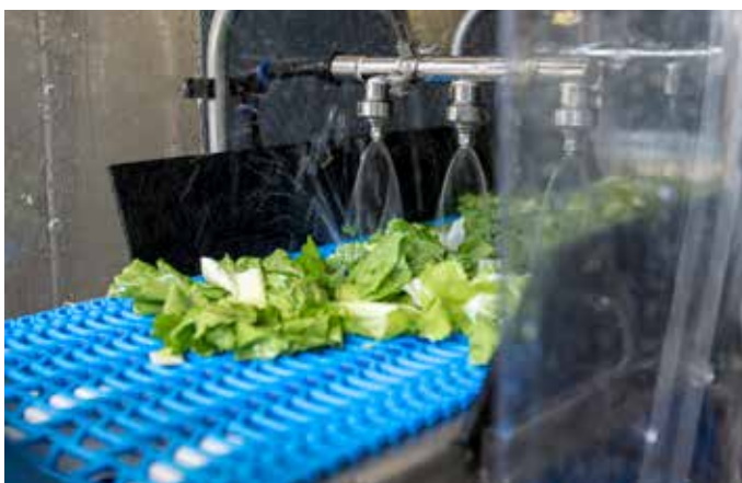
Plasmabehandeltes Wasser für die Hygienisierung von frisch geschnittenem Salat in einer handelsüblichen Waschmaschine. Die mikrobielle Belastung konnte deutlich reduziert und so ein sichereres Produkt für die Verbraucher bereitgestellt werden. Die Markteinführung des Verfahrens steht noch aus.
