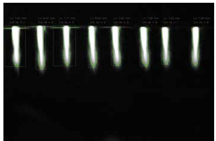
Automatisierte Qualifizierung der Effluentenlänge bei einer 8-fach Anordnung eines Plasmajets
