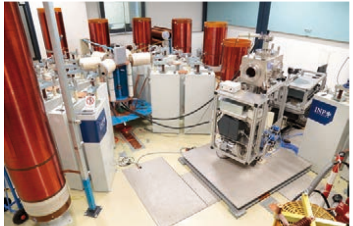
Ein Blick ins Lichtbogenlabor: Stoßstrom-Generator (links im Bild), Vakuumkammer mit Pumpensystem und Antrieb (rechts im Bild).
