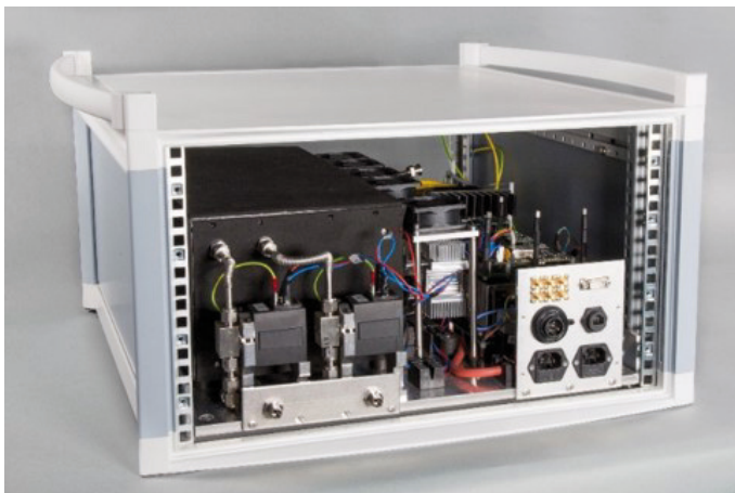
CELISE-Prototyp für die Spurengasdetektion (im Aufbau befindlich)
