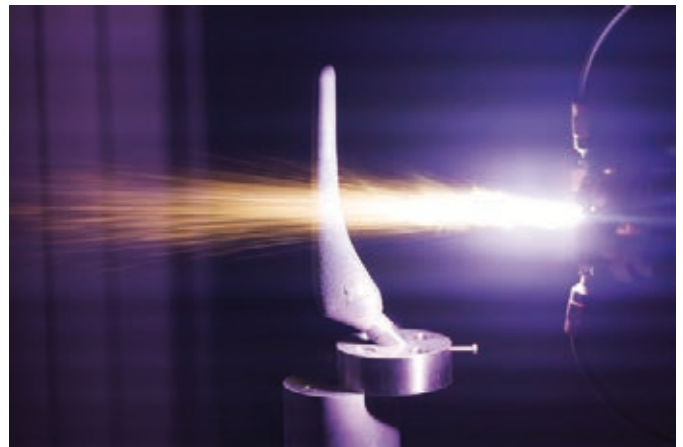
Anwendung des Plasmasprayverfahrens zur Beschichtung eines Implantats
