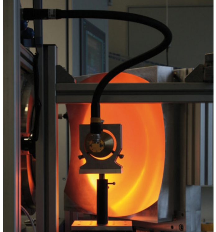
Elektronendichtemessung mit einem 50 GHz-Interferometer an einer Niederdruckplasmaentladung
