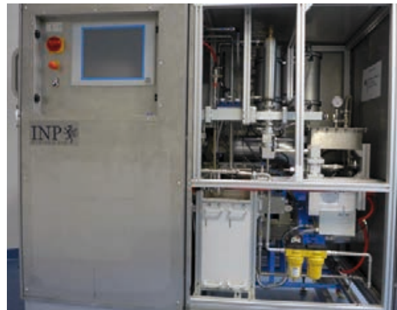
Mikrowellenangeregter Prozessgasgenerator für die biologische Dekontamination von Pack- und Lebensmitteln
