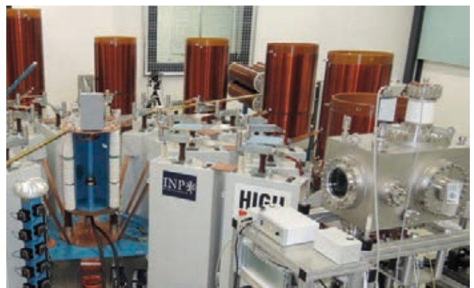
Stoßstromgenerator und Vakuumkammer im Lichtbogenlabor
