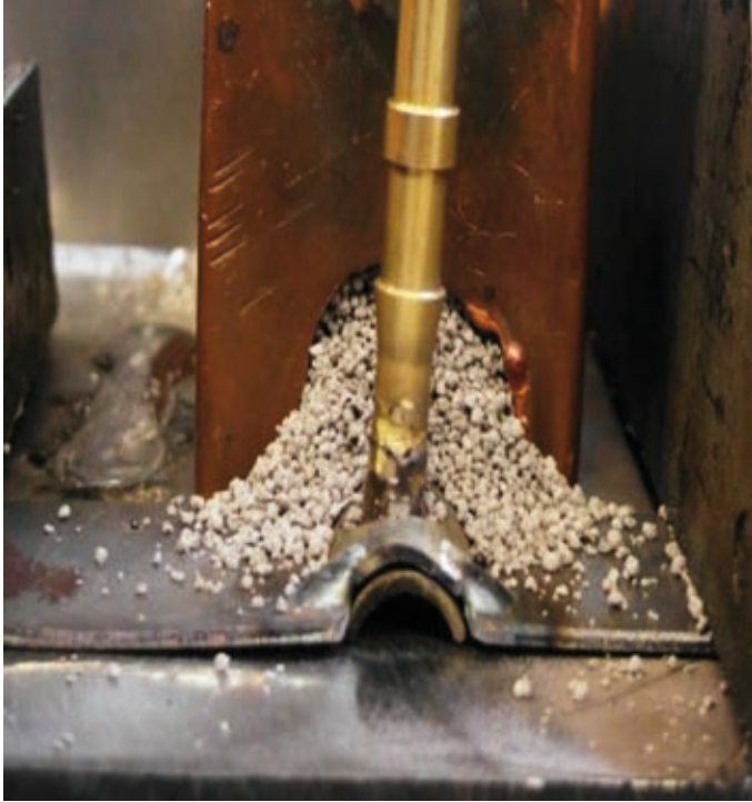
Setup zur optischen Analyse eines Unterpulver-Schweißprozesses für das Fügen hochfester Stähle.
