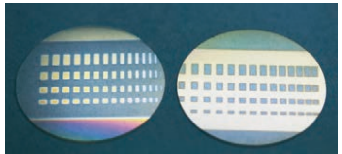
Strukturierte Substratoberfläche nach der Plasmabehandlung.
