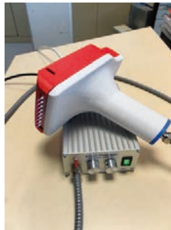
Abbildung 2: Funktionsmuster eines Plasma-Jet-Arrays mit 8 sequentiell oder simultan zündenden Effluenten.
